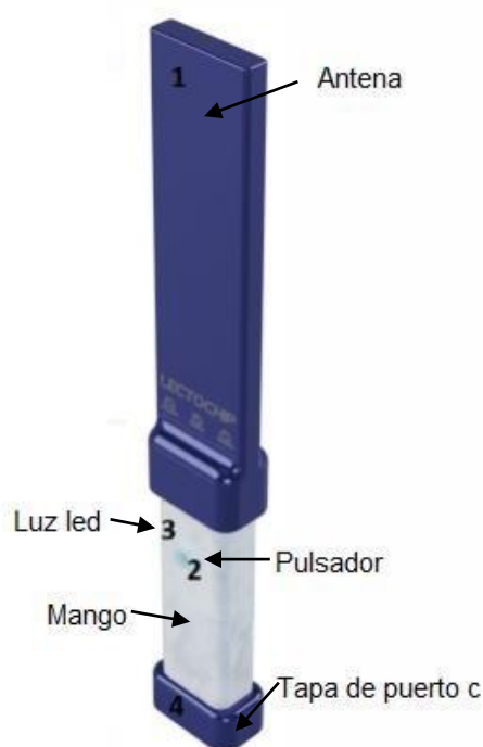
Figura 1. Imagen de Lectochip y sus partes
